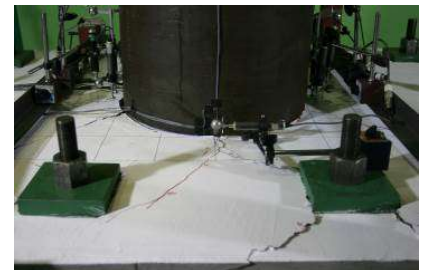
(a) 試験後の杭体とスタブの状況
