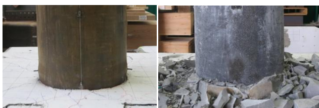
写真.2 試験後の杭体の状況 (NO.3-2)
