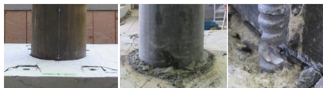
写真.3 試験後の杭体の状況 (NO.4)
