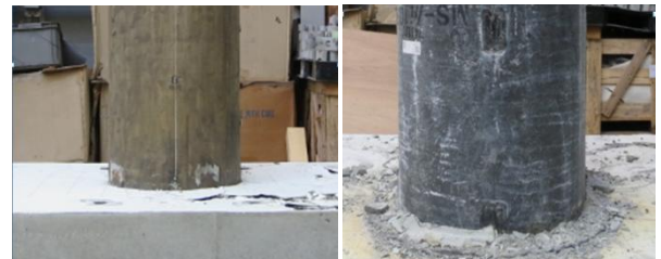
写真.2 試験後の杭体の状況 (NO.2)
