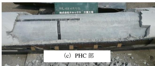
図.4 SPHC 杭の破壊時の状況の一例
