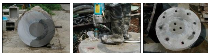
(a)切断状況 (b)コア抜き状況 (c)コア抜き後状況 写真1 根固め球根部切断および供試体採取例
