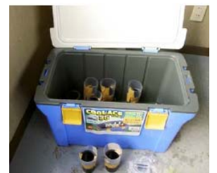
図5 事務所内養生例
